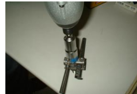
レンチで締めれば完成
